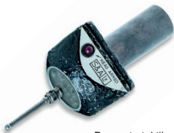
Der erste taktill schaltende Messtaster der Welt
