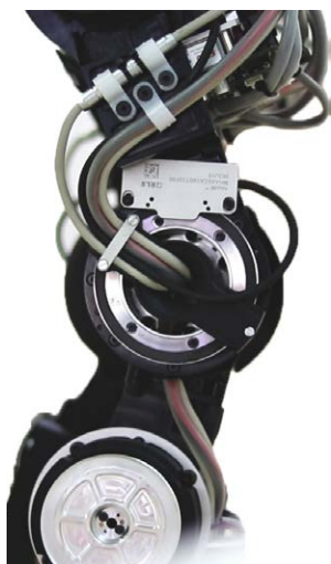
REEM-C knäled med absolut roterande pulsgivarsystem AksIM™
