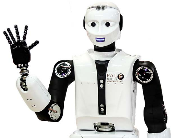
REEM-C med roterande pulsgivare AksIM och Orbis integrerade i armbågs- och handleds leden.
