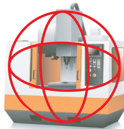
Perfekta cirklar längs X-, Y- och Z-axlarna definierar en perfekt maskin
