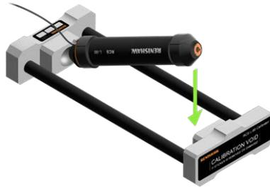
2. 延长设备, 使伸缩支撑杆的另一端到达校准装置的另一端球面。确保以磁吸方式将RCS L-90伸缩支撑杆连接至校准装置。
